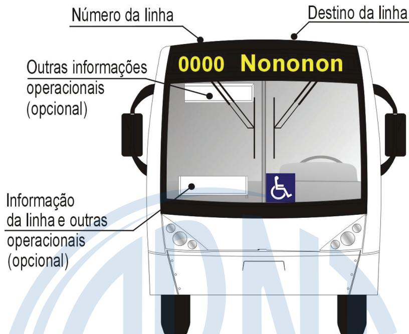
**Figura 13 — Exemplo de identificação visual frontal do destino e número da linha no veículo**
