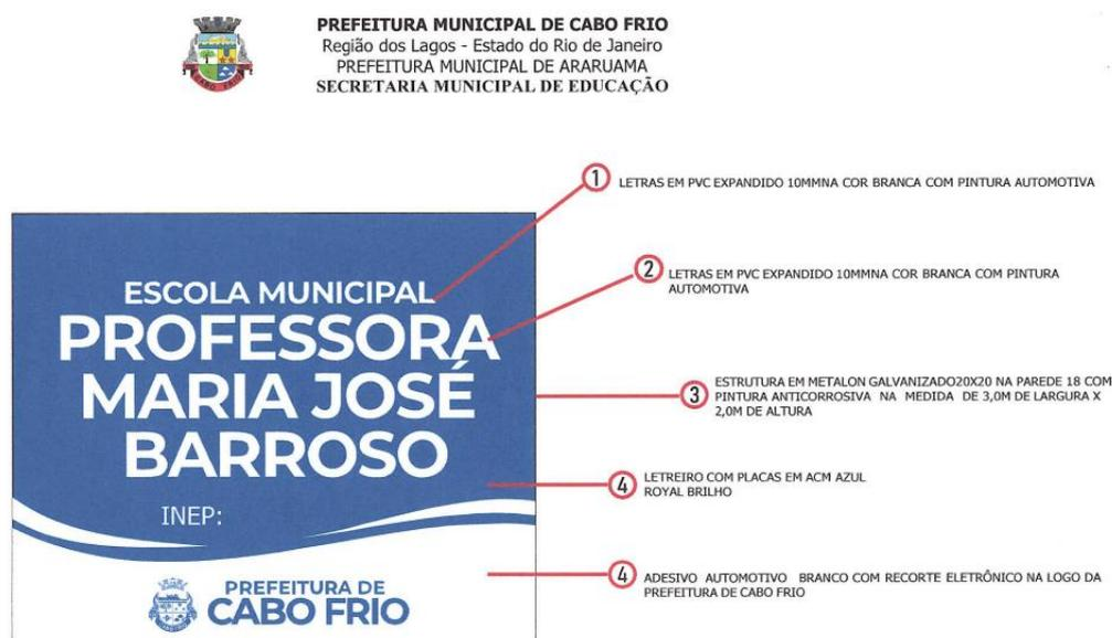
QUANDO A PLACA FOR FIXADA NA PAREDE SERÁ UTILIZADA UMA FIXAÇÃO EM METALON GALVANIZADO 20X20 NA PAREDE 18 E QUANDO FOR NECESSÁRIO FIXAR A PLACA NO SOLO SERÁ UTILIZADO 2 TUBOS DE 2.5" GALVANIZADOS NA PAREDE 18 COM 4M CADA (SENDO 1M ABAIXO DO SOLO E 3M ACIMA DO SOLO).
