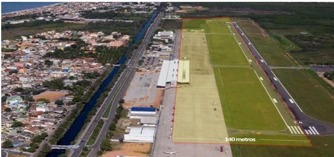
**Figura 116** – Não-Conformidade de Faixa de Pista para Operações por Instrumentos de Não-Precisão, considerando Aeronaves de Código 3 ou 4, em SBME.
