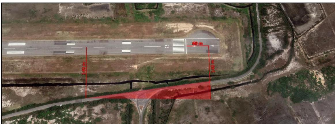
**Figura 107** – Não-conformidades de Faixa de Pista e de PBZPA em SBCB junto à Cabeceira 28.
