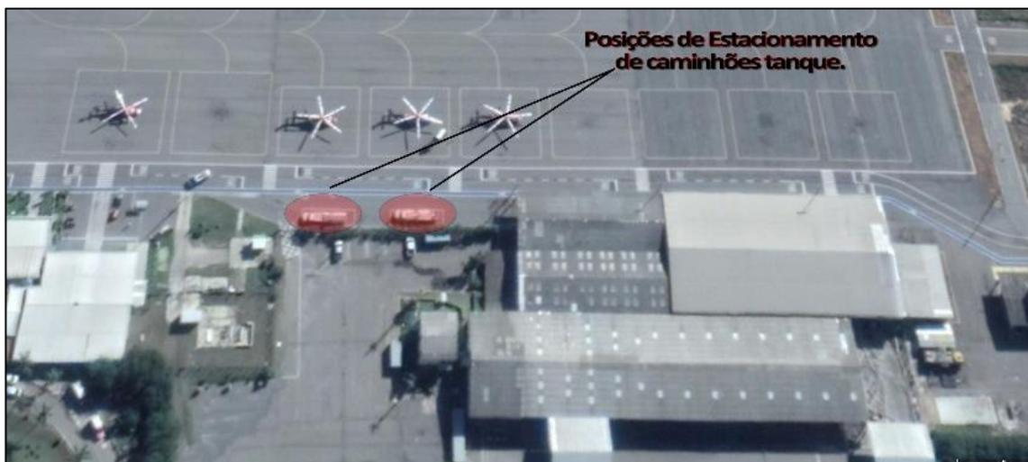
**Figura 98** – Posições de estacionamento para caminhões de Abastecimento de Aeronaves.
